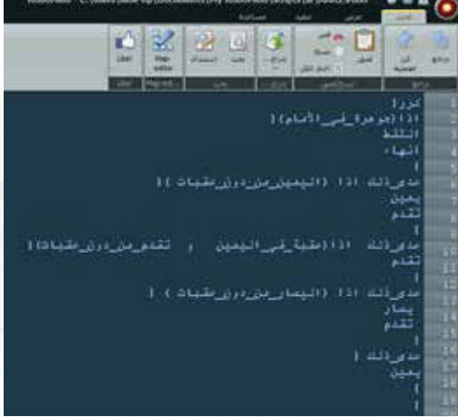
شكل (٤-٦-٦): أوامر برمجة ليقوم الروبوت على اتخاذ القرار المناسب وتجنب العقبات والبحث في المتاهة عن الجوهرة والتقاطها
