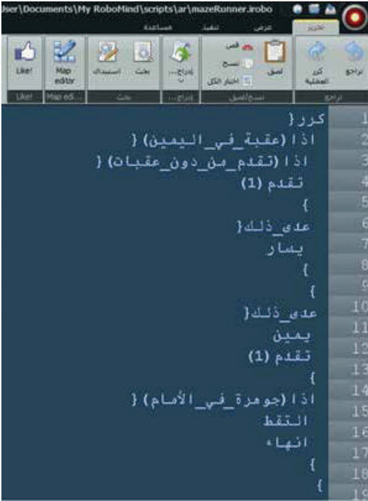
شكل (٤-٦-٣): برمجة الروبوت على اتخاذ القرار المناسب لتجنب العقبات والبحث في المتاهة عن الجوهرة والتقاطها
