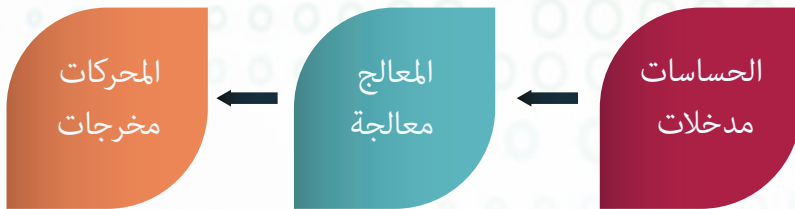
شكل (٤-٦): يوضح العلاقة بين مكونات الروبوت
